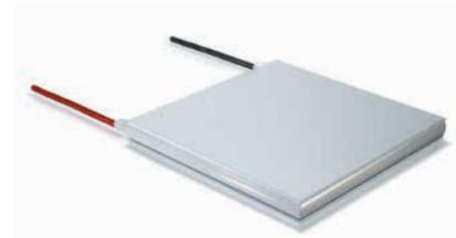
当社ではオプションとしてRTVシリコンを外部部に塗布したサーモモジュールを提供しています。このRTVシリコンシール仕様品は露点以下でサーモモジュールを駆動させる際の結露対策のひとつとして有効な手段になります。サーモモジュール内部に継続的に水蒸気の侵入が発生する場合は、性能劣化につながることがあります。RTVシリコンシール仕様品は塗布後も柔軟性があり、時間が経っても弾力性を保ちます。この特性は厳しい温度サイクルの条件下で使用される場合に非常に効果的です。当社のRTVシリコンシール仕様品は-60°Cから+200°Cまでの温度範囲で効果が発揮されます。
