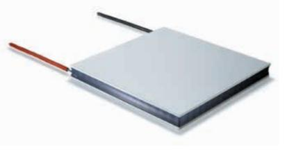
エポキシシール仕様品は高湿度環境下で使用されるサーモモジュールの防湿対策のために提供しています。RTVシリコンシールが効果的な湿度対策であることは実証されていますが、弊社のエポキシシールは防湿対策を必要とするアプリケーションのためにより大きな耐湿性を発揮します。当社ではサーモモジュールのために最も有効な材料を選定するために多くのエポキシ系シール材料をスクリーニングと試験を行いました。サーモモジュールのシールとして使用されるエポキシ素材のいくつかは共通の問題として脆弱性があり、時間の経過とともに剥離につながったり、接着力が失われる原因になったりする場合があります。当社のエポキシシールは基板と強固に密着することができ、硬化してからも柔軟性を保ち、これらの問題を解決しました。当社のエポキシシール仕様品は、激しい温度サイクルテストでも非常に優れた耐湿性を示しています。エポキシシールの推奨最大使用温度は+80°Cです。当社のエポキシシール仕様品は製品カタログにラインナップされているサーモモジュールに追加することができます。
